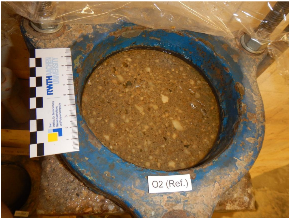
Abbildung 1: Eingebauter Prüfkörper im Prüfstand – Referenz Probekörper Nr. O2 bei einer Wasserdruckbelastung von 2 bar
