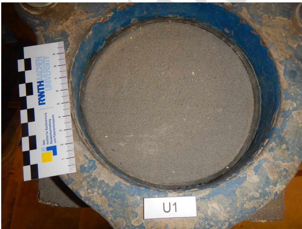
Abbildung 6: Eingebauter Prüfkörper Nr. U1 am Ende der Wasserdruckbelastung von 2 bar
