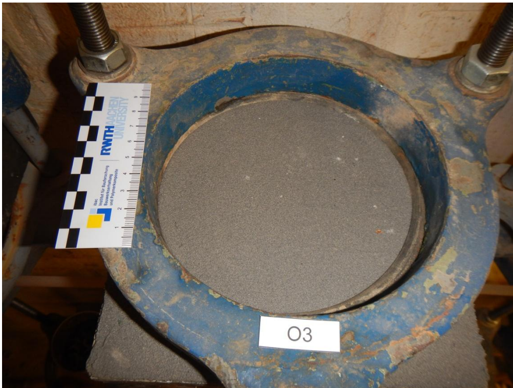
Abbildung 3: Eingebauter Prüfkörper Nr. O3 am Ende der Wasserdruckbelastung von 2 bar
