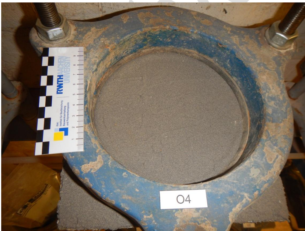
Abbildung 4: Eingebauter Prüfkörper Nr. O4 am Ende der Wasserdruckbelastung von 2 bar
