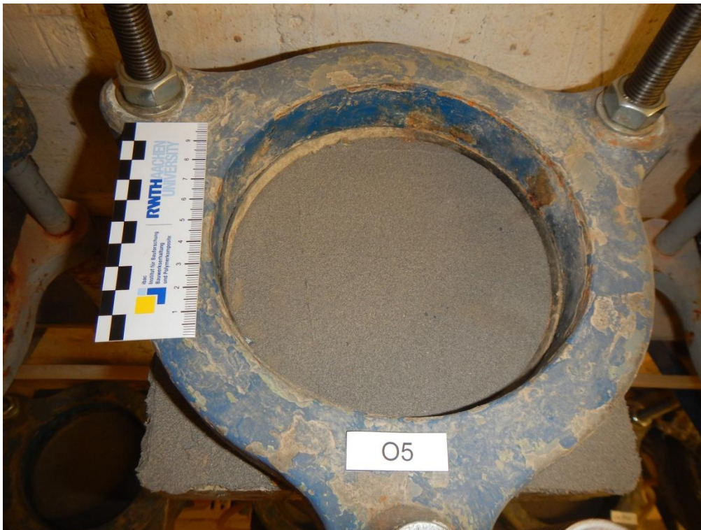
Abbildung 5: Eingebauter Prüfkörper Nr. O5 am Ende der Wasserdruckbelastung von 2 bar
