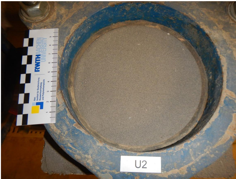
Abbildung 7: Eingebauter Prüfkörper Nr. U2 am Ende der Wasserdruckbelastung von 2 bar
